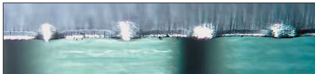
Рисунок 10. Лезвие под микроскопом с боковой подсветкой. Внизу - прозрачная линейка с миллиметровыми делениями.
