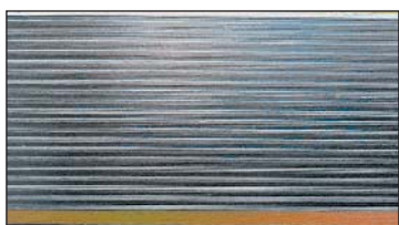
Рисунок 24. Вариант грубой структуры на тепло для классических лыж. Несмотря на страшный вид, глубина бороздок невелика — 30-40 микрон.
