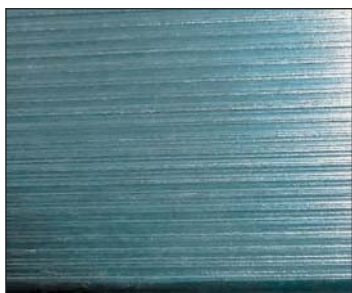
Рисунок 23. Вид комбинированной двухуровневой структуры на лыже. Шаг крупных бороздок 1 мм.
