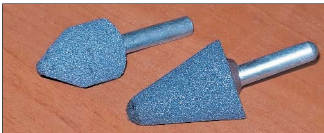
Рисунок 29. Шарошки для формирования структуры в желобке. Слева - для ROSSIGNOL, справа - для FISCHER.
