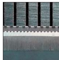
Рисунок 13. Сравнительные размеры зубчиков. Вверху линейка с миллиметровыми делениями. Затем видна кромка лезвия с крупным шагом зубчиков, на нём лежит лезвие с мелким шагом зубчиков.
