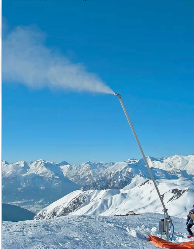
Снегогенератор Snowstar Phoenix с технологией внутреннего смешивания, является наиболее простым и рациональным техническим решением для трасс большой протяженности, нуждающихся в большом количестве стационарных пушек низкого давления
