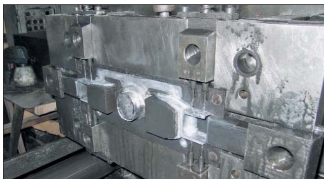
Сейчас снимок сделан с другой стороны станка. Пресс-форма разжата, а по сторонам вы видите «голки» и маленькие прессы, которые делают технологические отверстия для болтов и центральной оси колеса. При литье работают все четыре «голки», которые сжимают заготовку в четырёх направлениях. В пространство пресс-формы в этот момент идёт впрыск жидкого металла под огромным давлением. Графит, подающийся для того, чтобы движущиеся элементы станка не залипали, растекается по стенкам (потёки видны справа на кадре). В центре пресс-формы находится заготовка, в которой по бокам легко угадываются колёсные вилки. Металл, остывая в сомкнутой пресс-форме, отвердевает, заготовку вытаскивают, центральную часть отрубают и отправляют на переплавку, а вилки остаются. Далее вилки следуют на «косметическую» обработку, после чего они уже готовы к использованию.
