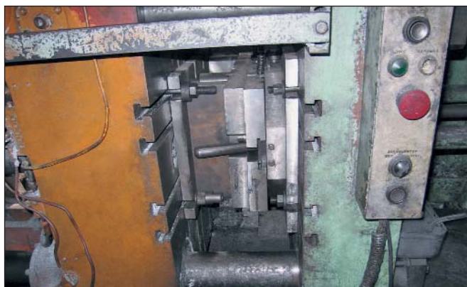
Перед нами пресс-форма в сомкнутом виде. По полозьям, которые находятся сверху и внизу фотографии, движется защитный кожух. Справа под блоком управления с кнопками находится ёмкость для графита. Он подаётся в пресс-форму и остальные части станка для того, чтобы движущиеся элементы не залипали. Справа за блоком управления, чуть выше центра фотографии виднеется труба, по которой подаётся металл. На снимке отчётливо видны «рельсы», на которых крепится в станке пресс-форма. На одной машине можно лить сразу несколько деталей, только меняя при этом «начинку».
